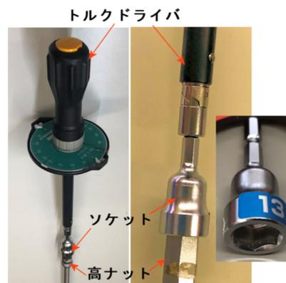
写真2-8 ドライバ型トルク計
