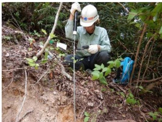
図 2-10 表層崩壊におけるベーンコーンせん断試験の地点配置と試験状況の事例
