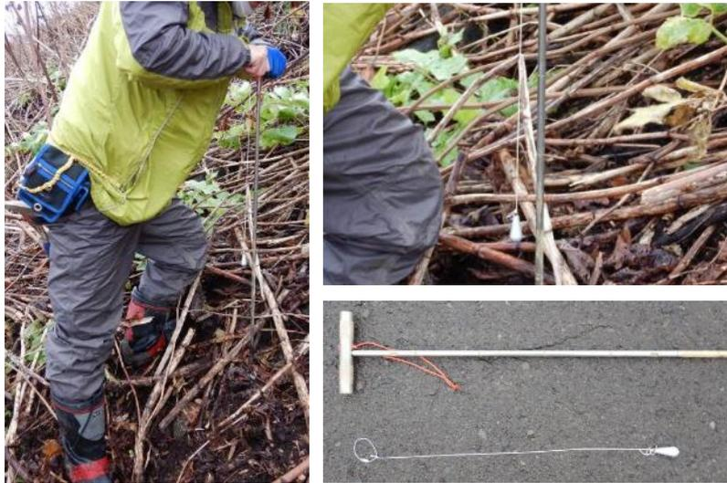
写真 2-5 下げ振り（錘をつけた糸）を用いた鉛直方向の貫入の確保の例
